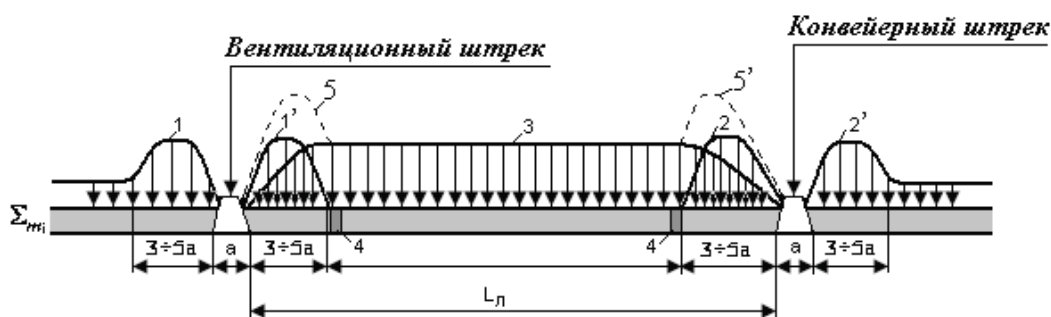
Рис.2. Схема формирования напряженного состояния горного массива впереди лавы и выработок, примыкающих к очистному забою: 1–1' – зона опорного давления от действия вентиляционного штрека; 2–2' – зона опорного давления от действия конвейерного штрека; 3 – зона опорного давления впереди лавы; 4 – зона ослабленных пород, являющаяся дополнительным источником поступления метана в лаву; 5–5' – суммарная эпюра напряжений в области, где наблюдается одновременное действие опорного давления от штрека и лавы; L_{л} – длина лавы; a – пролет штрека
